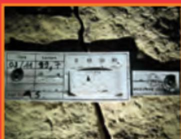
Lorsque des mouvements de terrain présentent un risque pour la population, des fissuromètres sont installés pour contrôler l'évolution du phénomène
