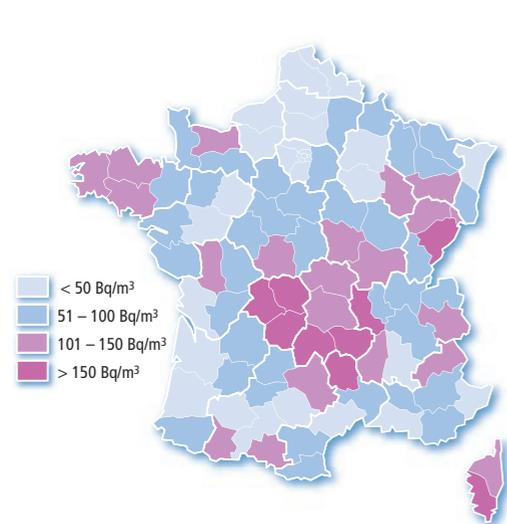
L'IRSN de 1982 à 2000 a réalisé 12 641 mesures de l'activité volumique (1) du radon dans des habitations de la France métropolitaine. C'est sur la base de ces données, qu'un Atlas radon a été réalisé. On peut le retrouver sur le site de l'IRSN : [www.irsn.fr](http://www.irsn.fr)
